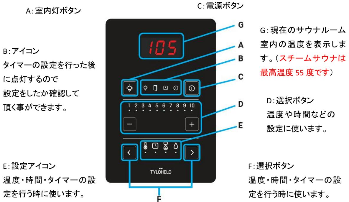
1. 下段(図 E)の一番左側の温度計アイコンが点灯しているのを確認してください。(もし温度計アイコン以外のものが点灯している場合は左右矢印ボタンを使って温度計アイコンを点灯させて下さい)
